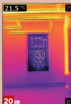
Thermografisch en origineel beeld van kantoor in het Arsenal te Leiden met geactiveerd akoestisch klimaatplafond – verwarmd
